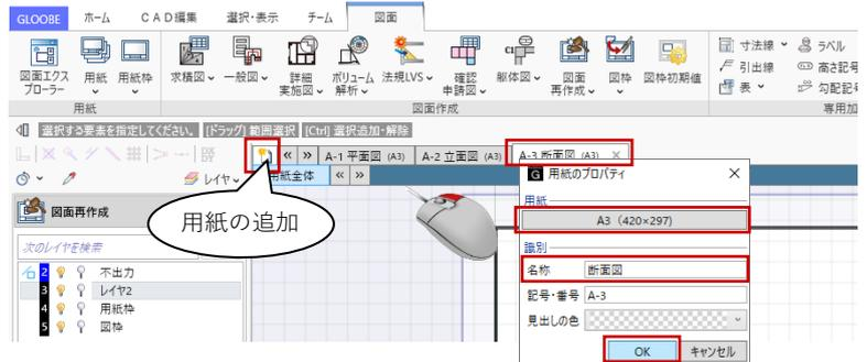
「図面」タブの「一般図」メニューから「断面図」をクリックします。
