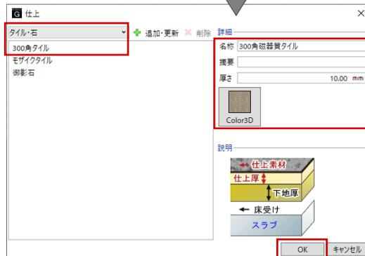
「仕上」ダイアログが開きます。リストボックスから、「タイル・石」の「300角タイル」のテンプレートを選び、次のように設定して「OK」します。
