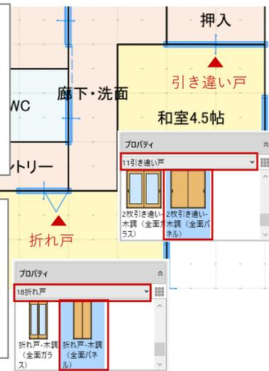
表示階を 2F に切り替えて、内部の建具を 1F 同様に inputs します。
